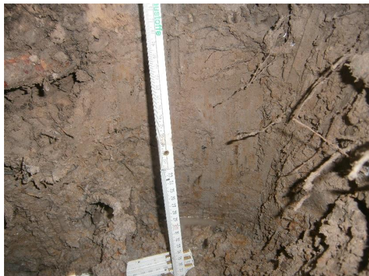
Abbildung 10: Das Profil Nummer 1 mit hydromorphen Merkmalen. In ca. 35 cm Tiefe ist Stauwasser zu erkennen (Quelle: Eigene Aufnahme 2016).
